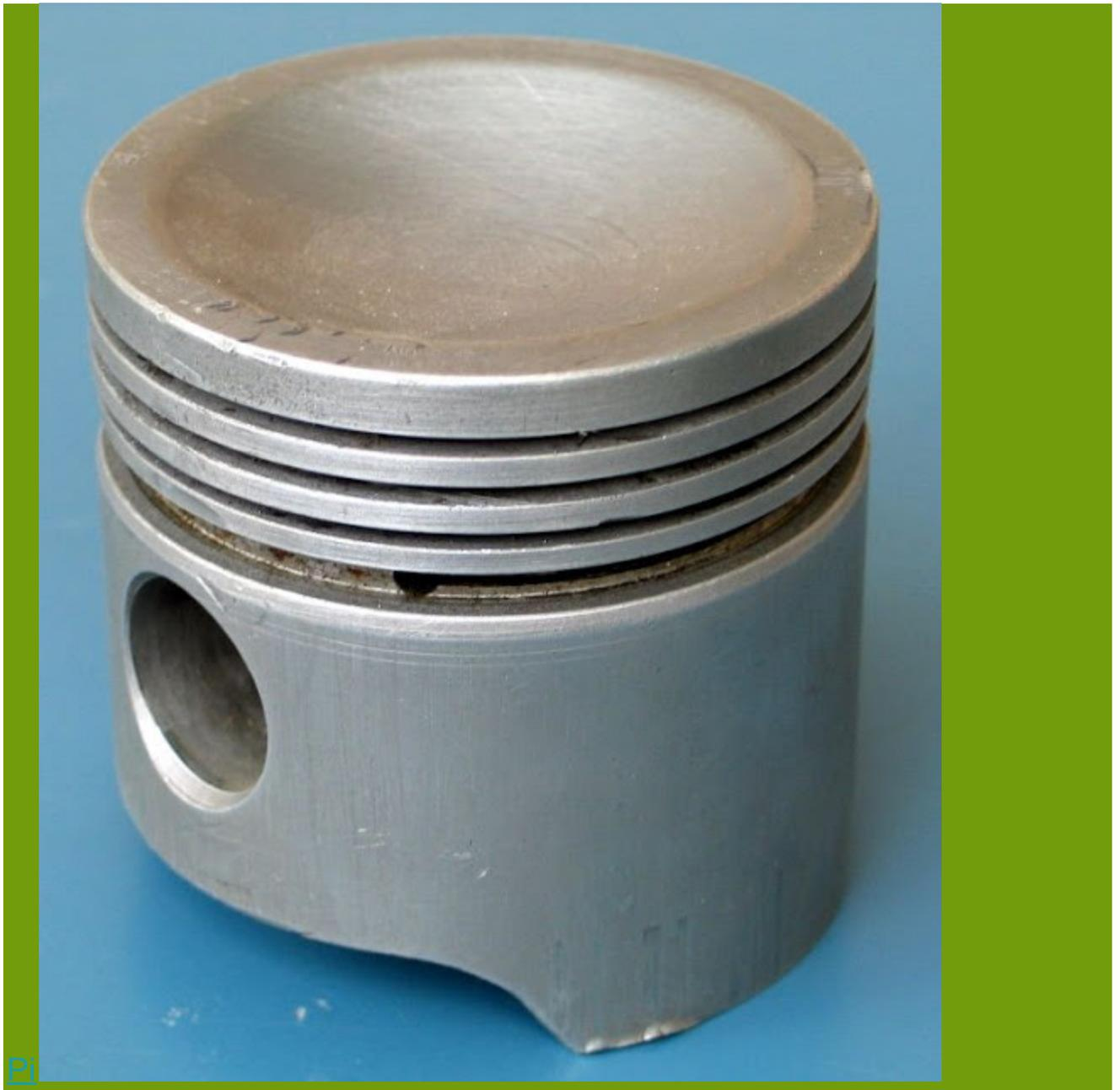
Internal combustion engine में piston, fuel की chemical energy को mechanical energy में convert करता है piston cylinder में reciprocating motion करता है piston cast iron या Aluminium alloy के बने होता है piston के उपरी भाग को head कहते है piston के परिधि के उपरी भाग पर ring grooves कटे होते है दो grooves के बीच की दूरी को लैंड होता है last grooves से नीचे भाग Piston Skirt कहते है piston pin को रोकने के लिए skirt के दोनों तरफ अन्दर की ओर बॉस बने होते है.
