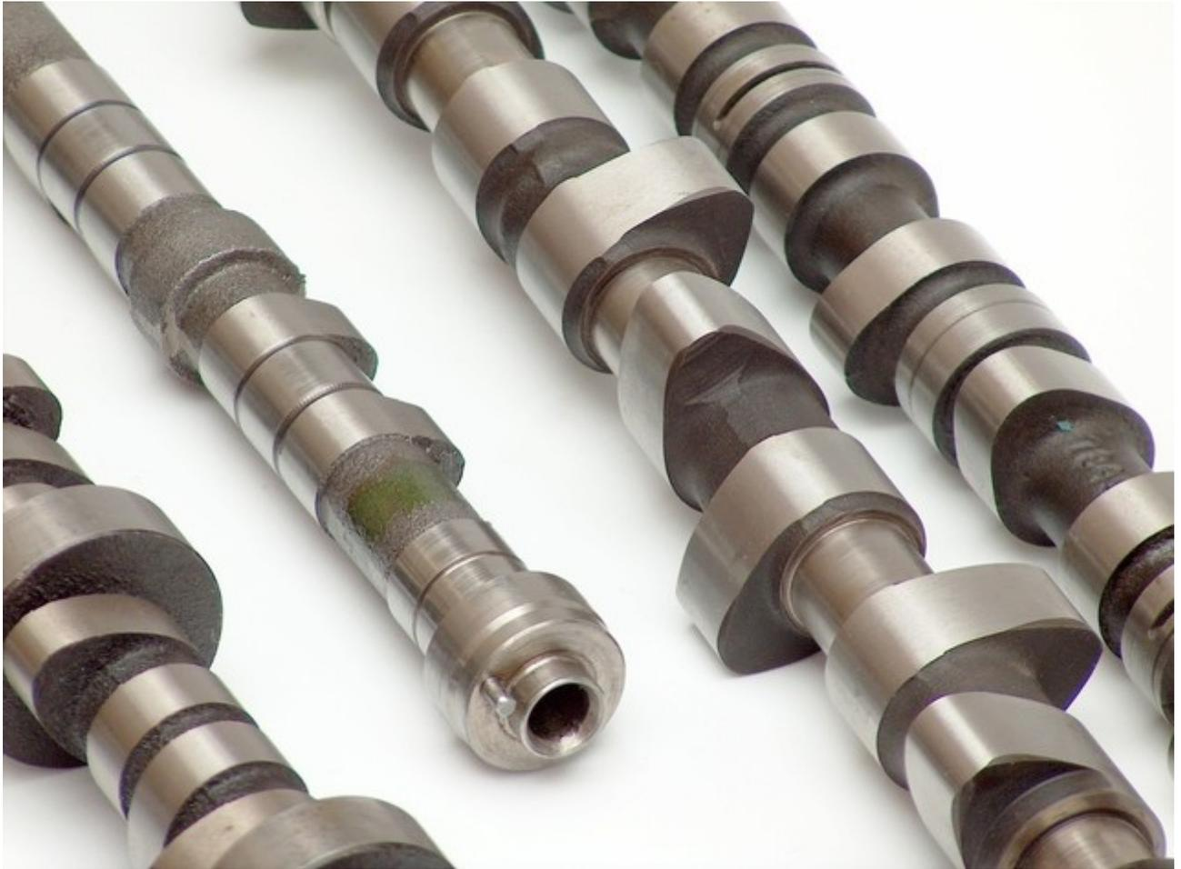
cam shaft का कार्य valve को open and close करने के लिए किया जाता है cam shaft पर कई cam लगे होते हैं प्रत्येक cylinder के लिए दो दो cam लगे होते हैं एक inlet valve दूसरा outlet के लिए, and fuel pump को चलाने के लिए एक eccentric and वितरक को चलाने के लिए गियर लगा होता है cam shaft को speed crank shaft से timing गियर के संबंध मिलती है cam shaft के गियर के दातों की संख्या crank shaft के गियर के दातों की संख्या से दुगुनी होती है यह mediam carbon का बना होता है.
